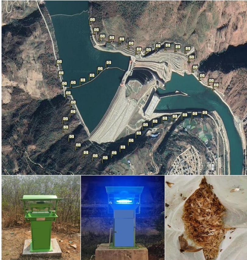
图 6 苗尾电站白蚁诱捕灯布置、安装及效果图
