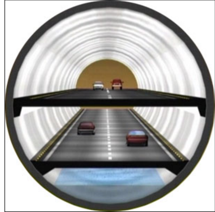
吉隆坡SMART隧道在中等降雨的情况下可同时容纳汽车交通和洪水，如果暴雨洪水持续不断，操作员可关闭隧道，淹没行车道以获得更大的容水量。
