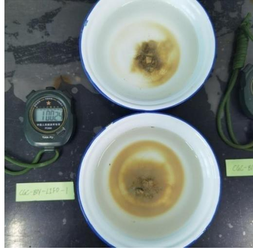
图 10 1 号试样土块试验 1h 状态
