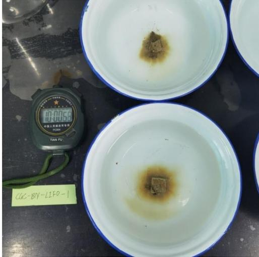
图 9 1 号试样土块试验 10min 状态
