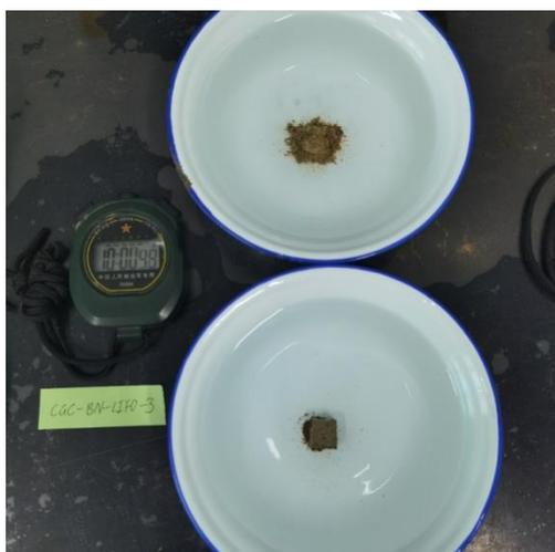
图 13 3号试样土块试验 10min 状态
