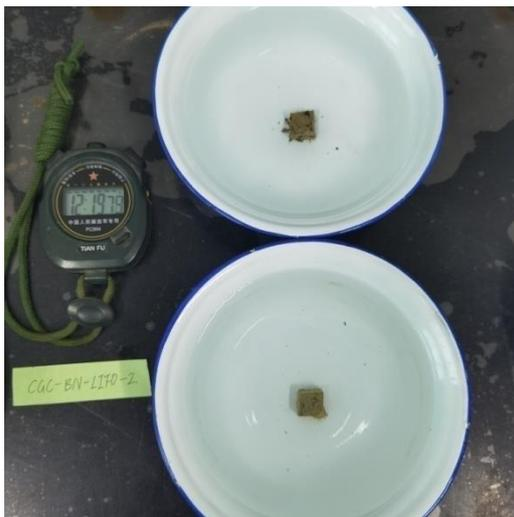
图 11 2 号试样土块试验 10min 状态
