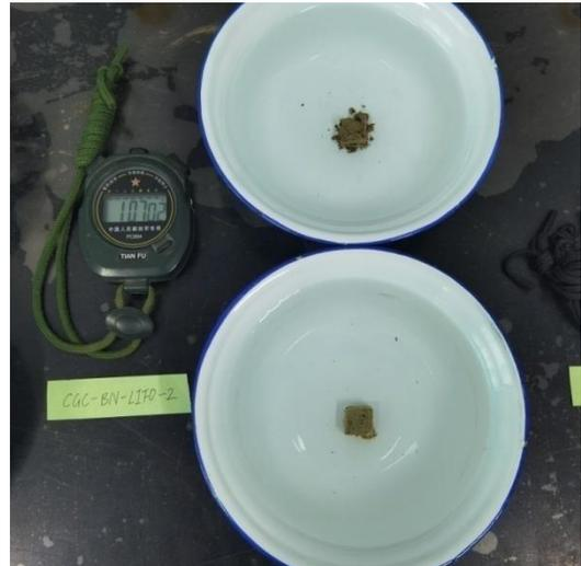
图 12 2 号试样土块试验 1h 状态
