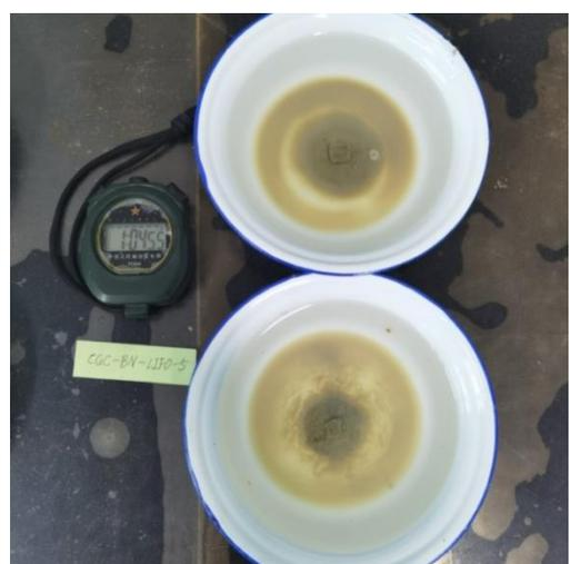
图 16 4号试样土块试验 1h 状态
