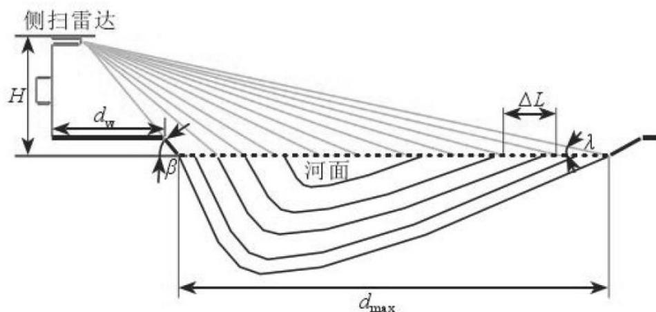
图 B.1 侧扫雷达安装夹角要求示意图
